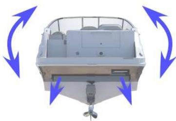
ACS A regola automaticamente la barca per l'assetto ottimo in asse longitudinale, migliorando la visibilità e attivando velocità nella gamma "semi-planata". Anche migliora la "hole shot".
